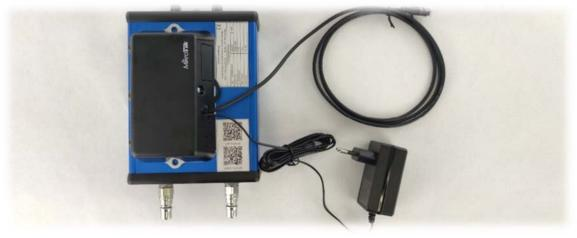
8. Schließen Sie das NEURON-Gerät über Schnellkupplungen an die Konsole an
