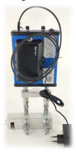
9. Schließen Sie den Stromanschluss an das NEURON- Partikelzählgerät an
